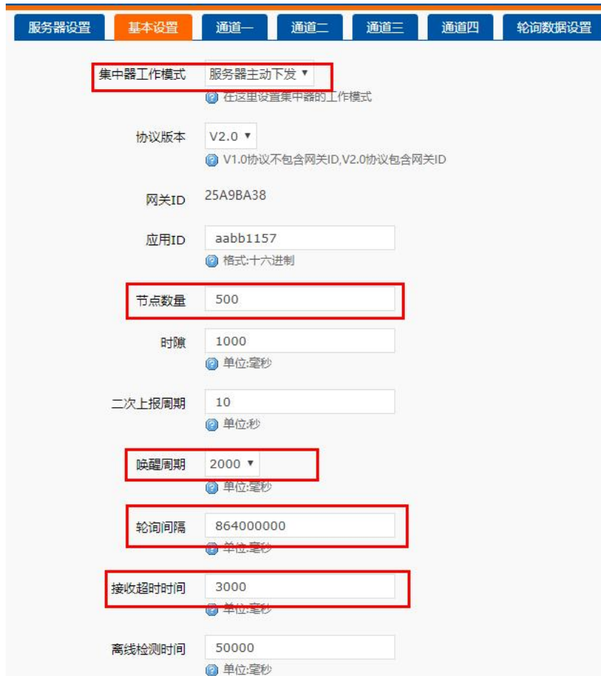
图 20 服务器主动下发基本设置
