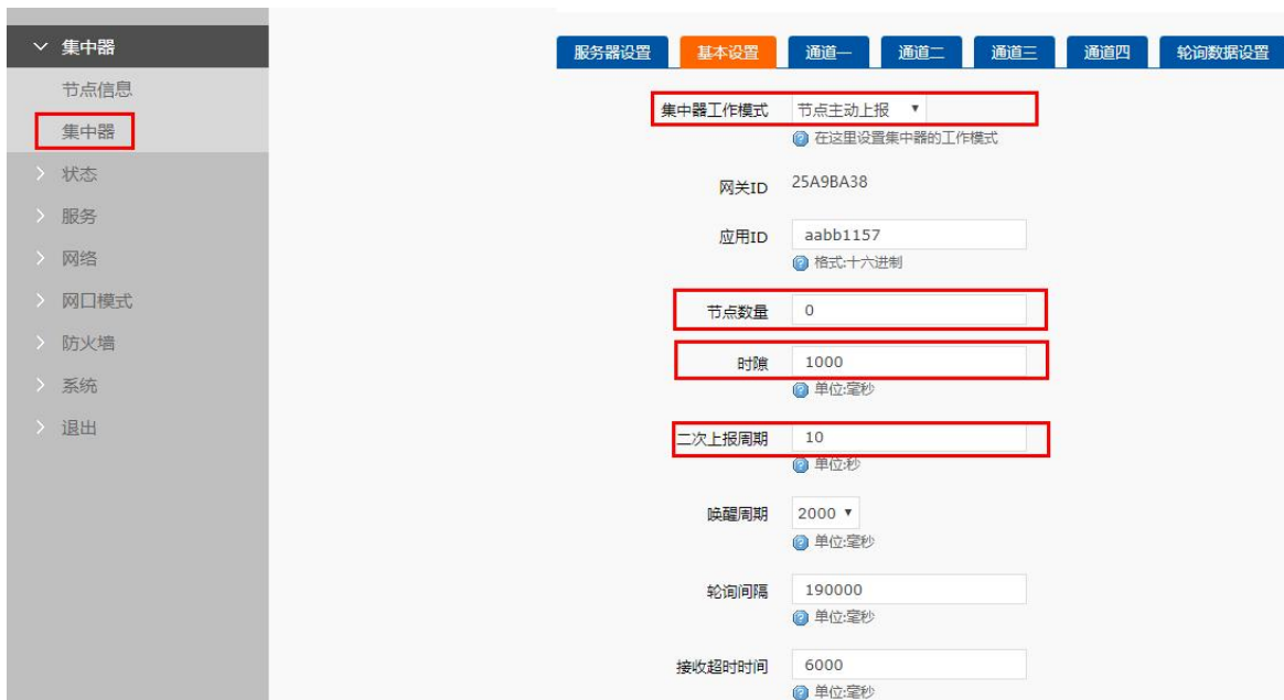
图 10 主动上报 Web 基本设置参数
