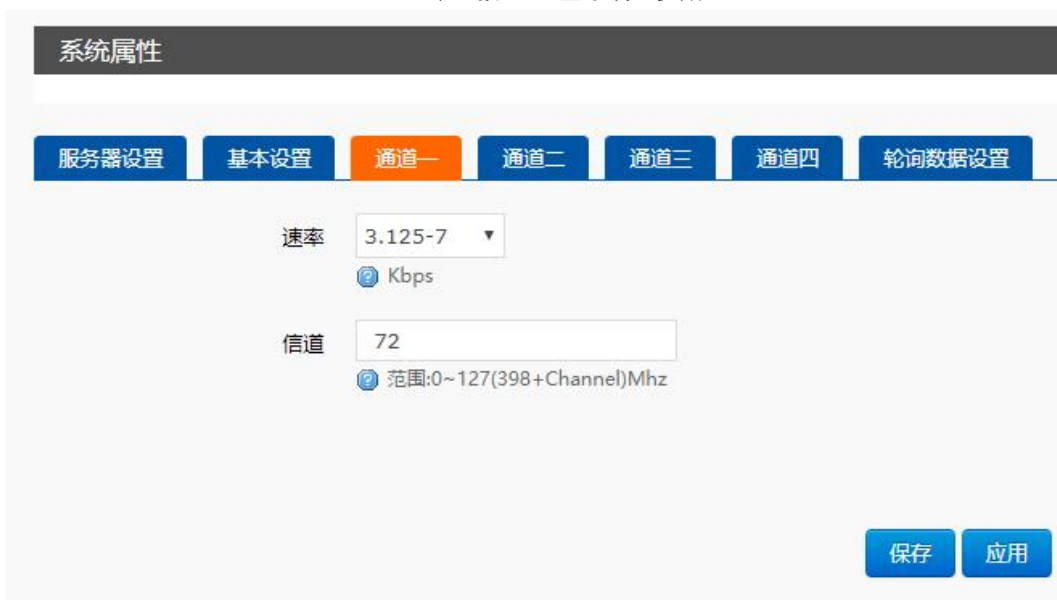
图 10 主动上报 Web 基本设置参数
