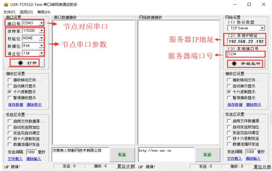
图 5 配置串口和本地服务器
